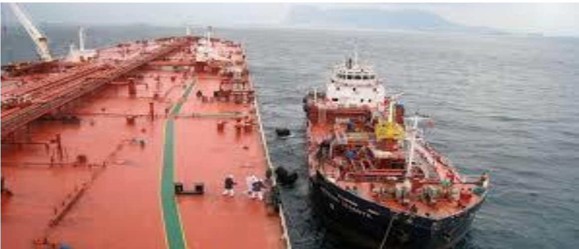
Cubierta de petrolero antes de iniciar aliје , las naves no atracan , todo es via boya o trasvasije a nave menor .
