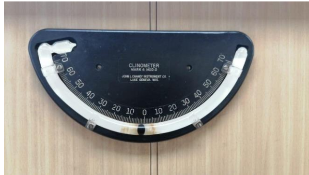
Clinómetro , marca los grados de escora de la nave.
