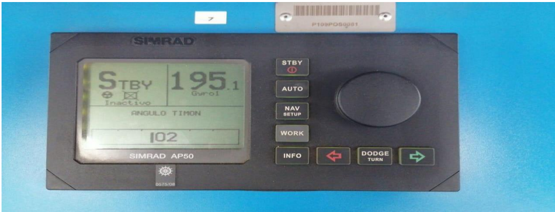
Control del piloto automático , permite programar el rumbo a seguir por el buque con los ajustes de timón para corregir las salidas .
