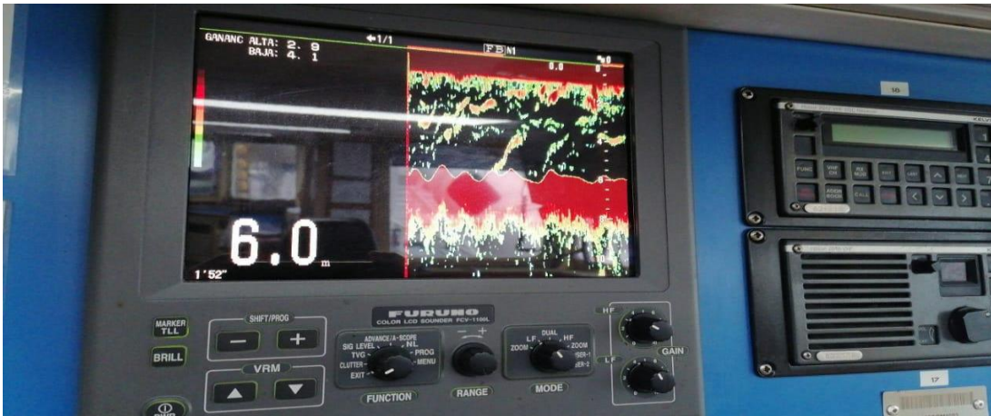
Ecosonda , instrumento que indica la profundidad bajo la quilla en metros
