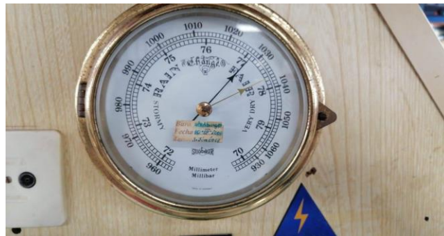
Barómetro , marca la presión atmosférica en milibares
