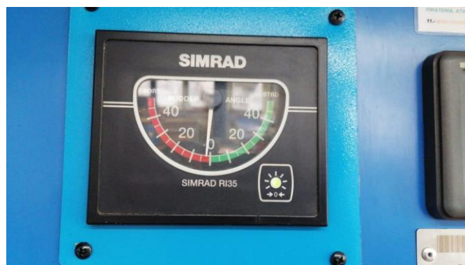
Axiómetro , indica los grados de ángulo del timón a babor o estribor
