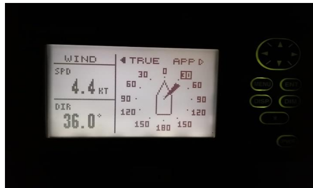
Anemómetro , mide la dirección y Velocidad del viento
