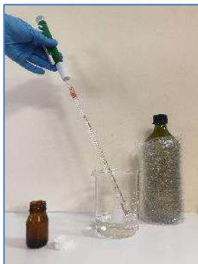
Figura N°8. Correcto empleo de pipeta y propipeta para fijar una muestra de hidrocarburos con Hexano.
