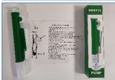
Figura N°10: Implemento que sirve para succionar o aspirar un volumen determinado de hexano, empleando la perilla del costado. La propipeta se debe adherir en la parte superior de la pipeta y nunca manipularla en posición horizontal, siempre vertical.
