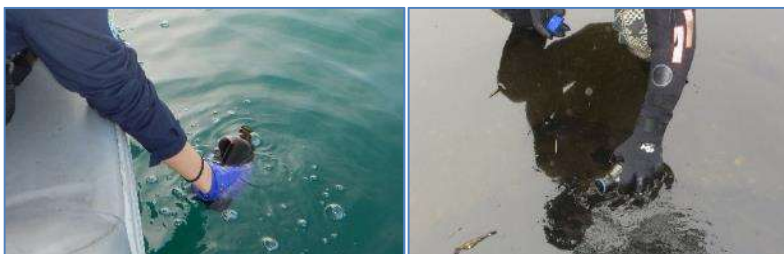
Figura 7: Toma correcta de muestra de hidrocarburos superficiales, utilizando guantes y posicionando la botella de forma horizontal objeto captar la mayor cantidad de película superficial del hidrocarburo.
