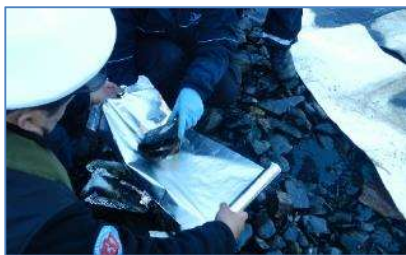
Figura 15: muestreo en paño absorbente – Figura 16: uso de papel aluminio para envolver paño absorbente.
