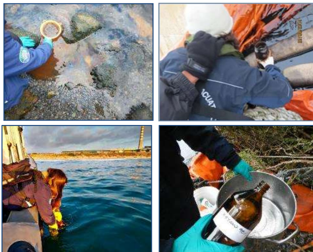
Figura 3. Procedimiento de tomas de muestras de hidrocarburo para análisis de correlación, ser utilizado en los sumarios administrativos.
