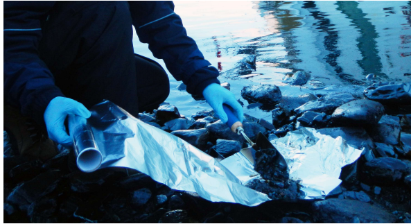
Figura 12: Correcto envoltorio de muestras sólidas.
