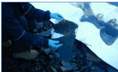
Figura 15: muestreo en paño absorbente – Figura 16: uso de papel aluminio para envolver paño absorbente.
