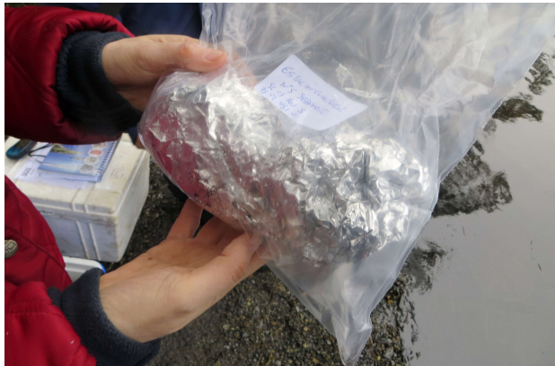
Figura 12: Correcto envoltorio de muestras sólidas.
