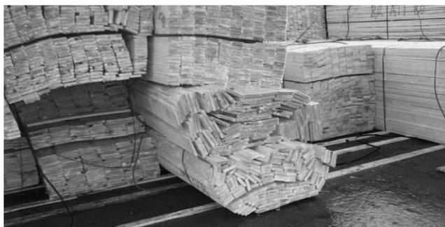
**Figura 6.2: Ejemplo de rigidez insuficiente**
