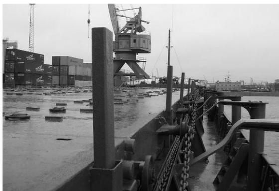
**Figura 6.7: Ejemplo de pies derechos para bloqueo de la base**
