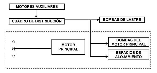
Figura 3.1: Esquema del sistema de propulsión y del sistema de alimentación eléctrica
