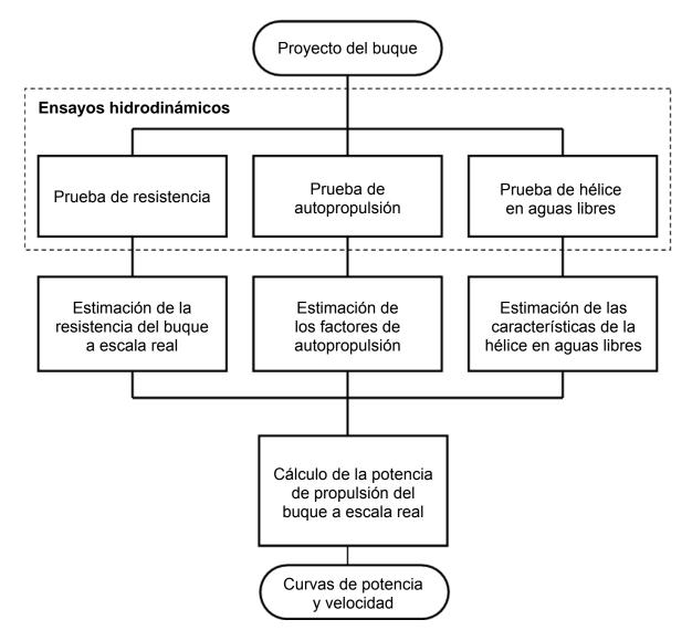
Figura 4.1: Diagrama de flujo del proceso para estimar las curvas de potencia
