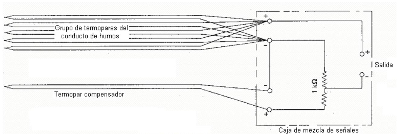
**Figura 7 – Diagrama de un circuito de termopares**
