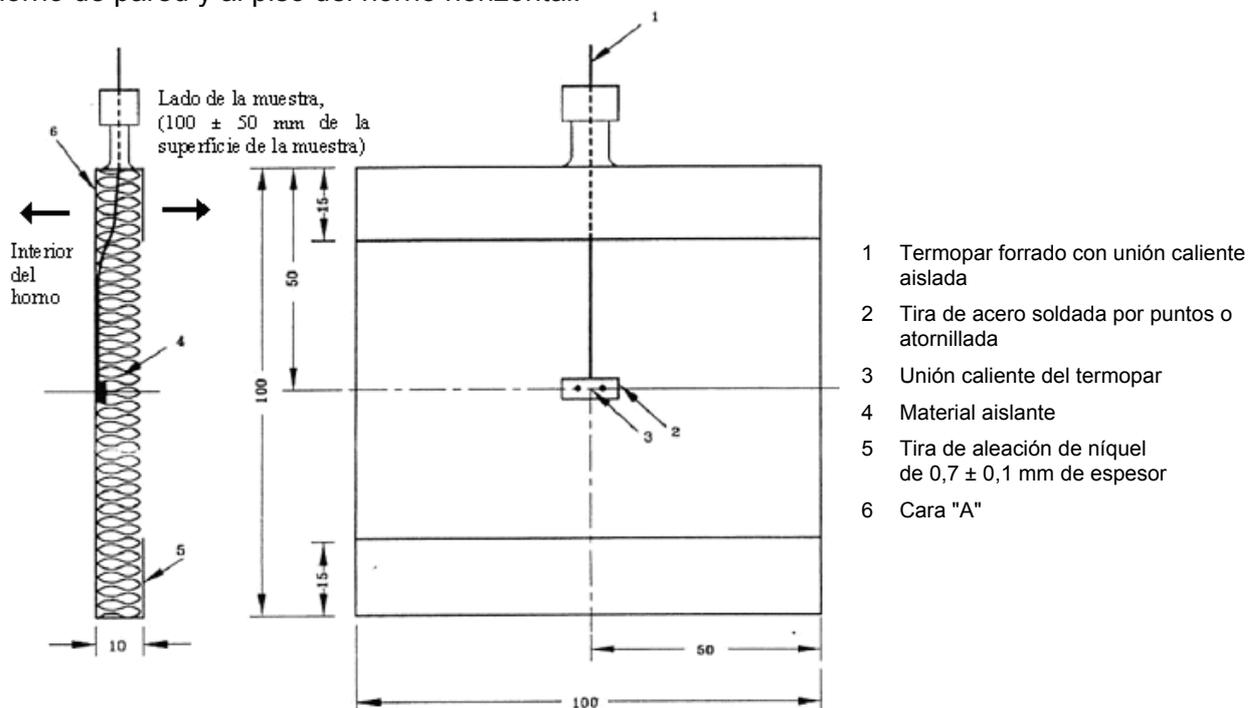
Figura 4 – Montaje de los termopares del horno
