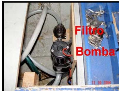
Vista de la bomba con la cubierta levantada
