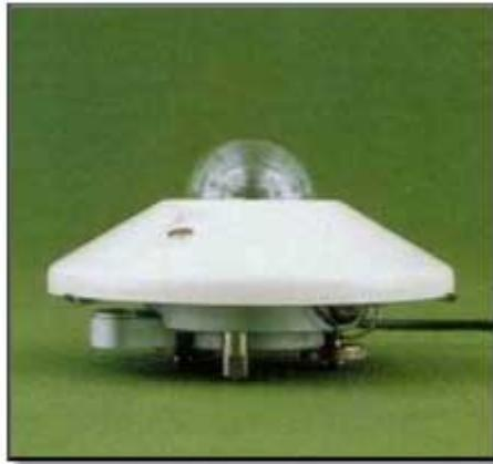
Piranómetro Radiación Solar Global
