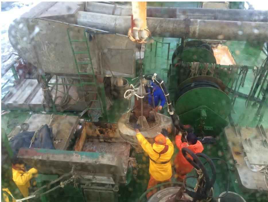
Imagen 3. Extremo succionador de la yoma, introducido en bodegas.
