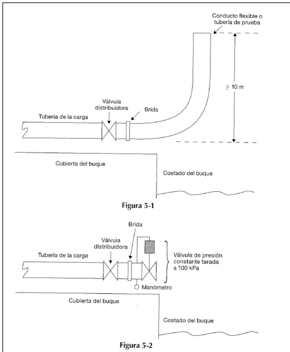
Las figuras anteriores ilustran medios de prueba que darán una contrapresión no inferior a 100 kPa en el colector de descarga del tanque de carga
