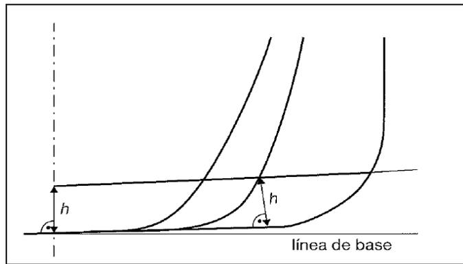
Figura 1: Límites de los tanques de combustible
