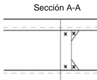
**Nota:** Mediciones que se tomarán en cada sección vertical según la vista A-A. En la sección central se efectuarán dos mediciones adicionales a la estructura interna del tanque del doble fondo.
