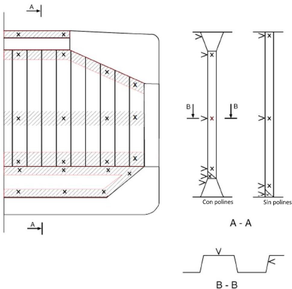
**Nota:** Mediciones que se tomarán en cada zona sombreada en las vistas A-A y B-B. Se añadirán mediciones adicionales a la estructura interna de los polines superiores e inferiores, por ejemplo, dos puntos en el polín superior y dos puntos en el polín inferior, las cuales deben indicarse en la sección A-A.
