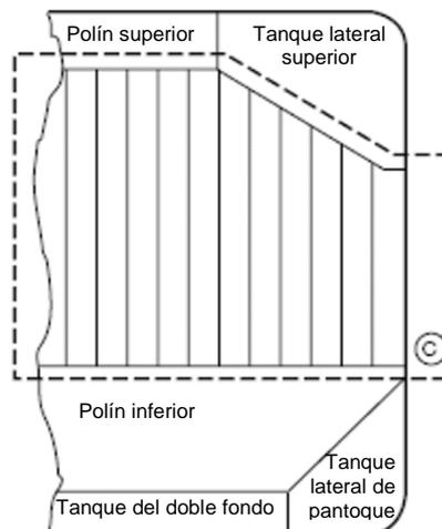
El espesor debería indicarse en el informe TM5-DSBC(CSR)
