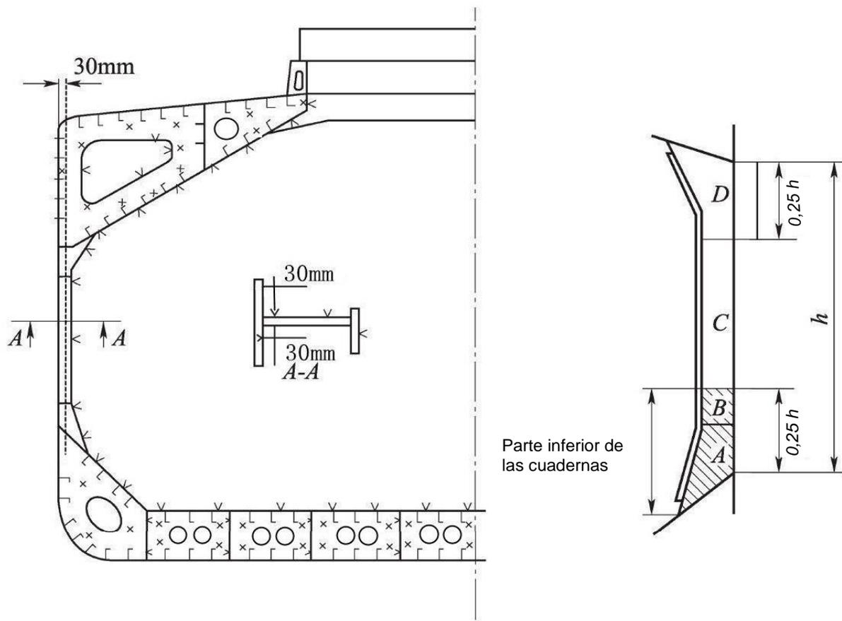
**Nota:** La determinación de las mediciones para el alma será de tres puntos para las zonas A, C y D, y de dos puntos para la zona B (véase la figura). El informe de determinación de mediciones deberá mostrar los espesores promedio. El espesor promedio se comparará con los espesores admisibles. Si el alma tiene un nivel general de corrosión, esta determinación se expandirá a cinco puntos.
