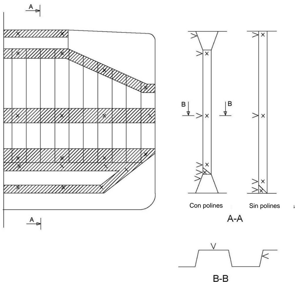
**Nota:** Mediciones que deben tomarse en cada zona sombreada en las vistas A-A y B-B. Se deben añadir mediciones adicionales a la estructura interna de los polines superiores e inferiores, por ejemplo, dos puntos en el polín superior y dos puntos en el polín inferior indicados en la sección A-A.
