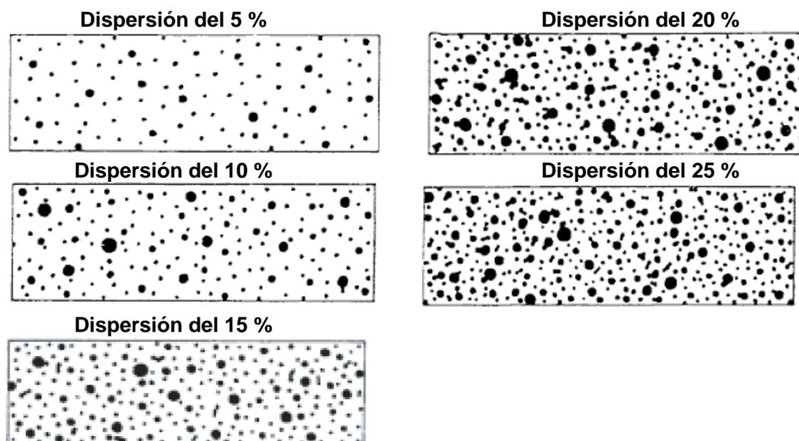
**Figura 2: Diagramas de concentración de picaduras
