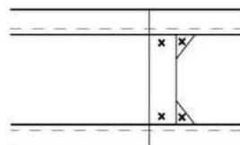
**Nota:** Mediciones que deberán tomarse en cada sección vertical según la vista A-A. En la sección central deberán efectuarse dos mediciones adicionales de la estructura interna del tanque del doble fondo.
