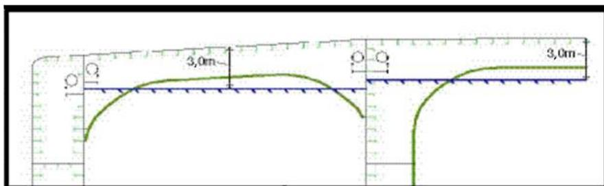
**Figura 1: Nivel máximo de agua en el tanque**
