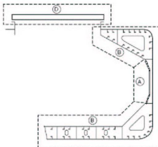
El espesor debería indicarse en los informes TM3-BC(CSR), TM4-BC(CSR), TM6-BC(CSR) y TM7-BC(CSR), según proceda
