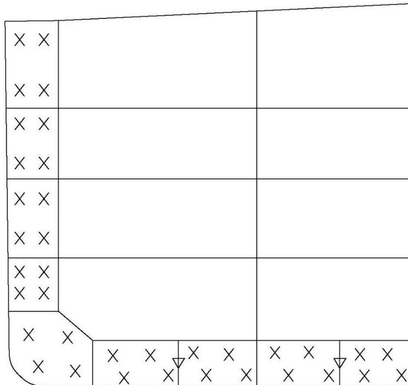
**Figura 8: Mamparos transversales de los tanques de lastre**
