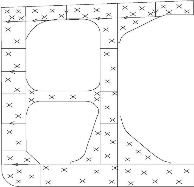
Figura 6: Anillos transversales en los tanques de carga y de lastre
