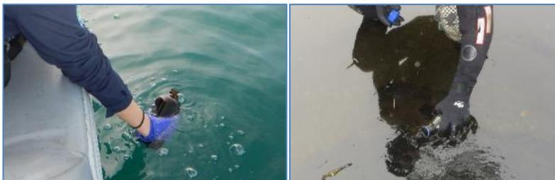
Una vez llenada la botella de 1 L hasta el borde, se debe fijar la muestra con el solvente Hexano (ver Figura N°8). Lo anterior significa adicionarle hexano para que la muestra se conserve y no se degrade.
