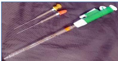
**Figura N° 9:** Implemento de vidrio que se debe utilizar adherido a una propipeta para obtener un volumen determinado de hexano.
