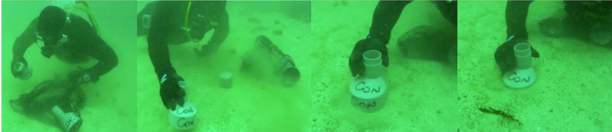
Se toma un tubo core abierto por ambos lados y se introduce por su parte más ancha en el sedimento, hundiéndolo suavemente hasta que solo sea visible el extremo superior.
