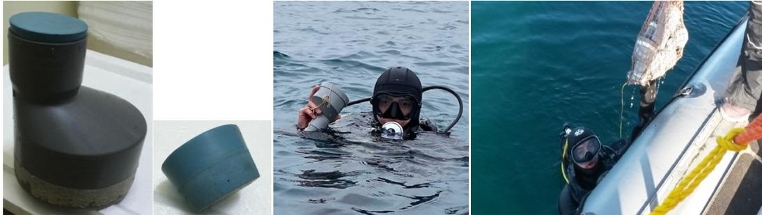
En el fondo, el buzo, debe introducir el tubo core cuidadosamente de forma vertical en el sedimento por la parte más ancha. Antes de retirar el core del sedimento, se pondrá el tapón de goma o tapa superior pequeña, luego se ladea el core lentamente y se tapa la sección inferior, de modo de hacer vacío para que la muestra quede compacta dentro del tubo, con el objeto de obtener una correcta medición de ORP y un análisis de contaminantes en el mismo estrato sedimentario.
