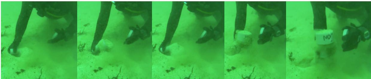
Muy lentamente, se ladea el tubo core y se saca del sedimento.
