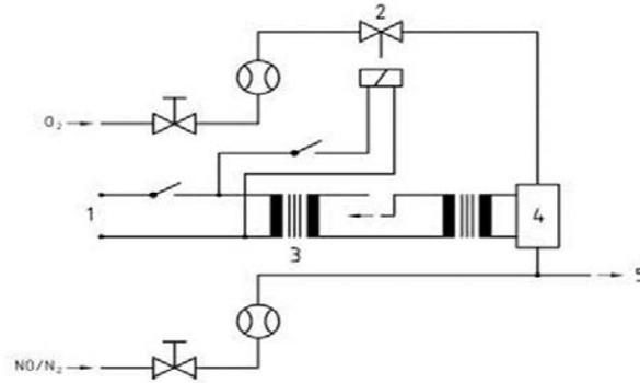
Figura 1 – Diagrama del dispositivo de ensayo de la eficacia del convertidor de NO<sub>2</sub>
