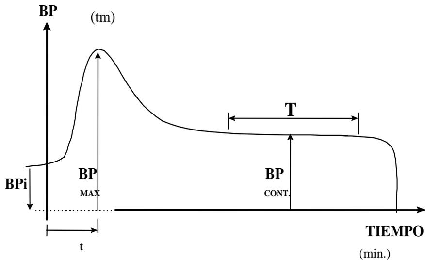
BPI = Bollard-Pull inicial    BPmáx.= Bollard-Pull máximo    BPcont.= Bollard-Pull continuo
