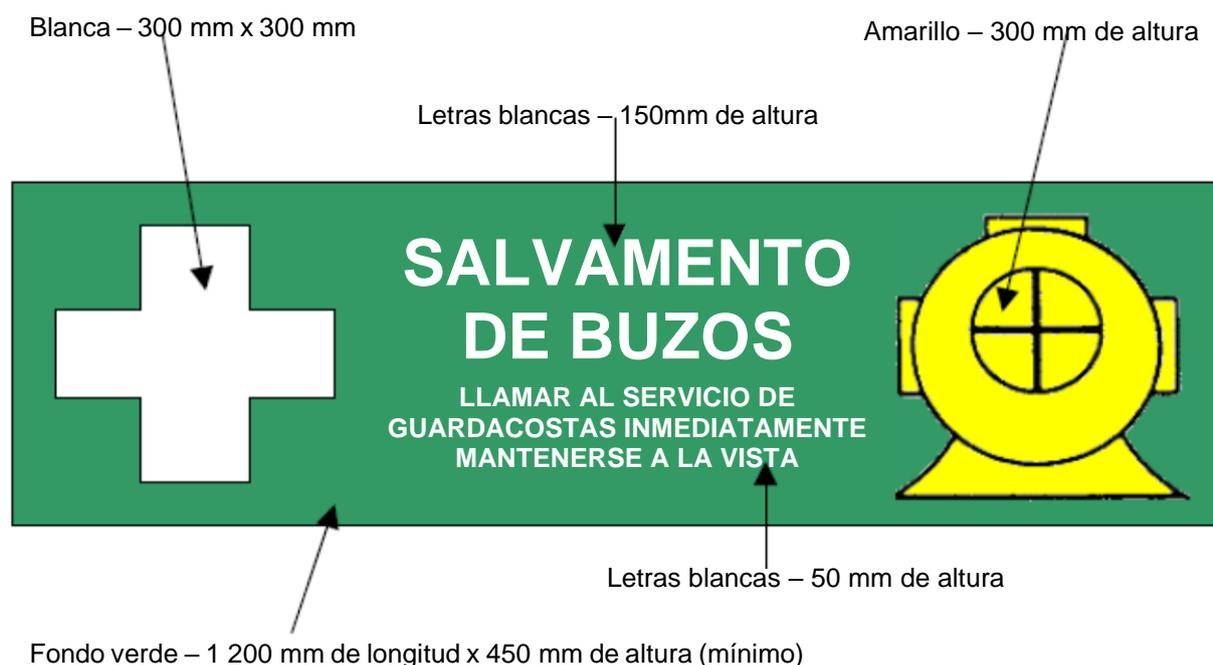
**Figura 3: Señal de rescate de buzos en una embarcación hiperbárica de supervivencia**
