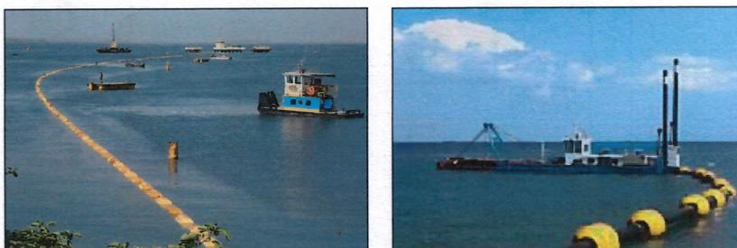
Imagen 21. Fotografías referenciales de Ductos Flexibles Superficiales.
